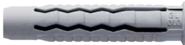
Universal-Nylondübel mit 4-fach-Spreizung für Vorsteck- und Durchsteckmontage; für Spanplatten- und metrische Schrauben
