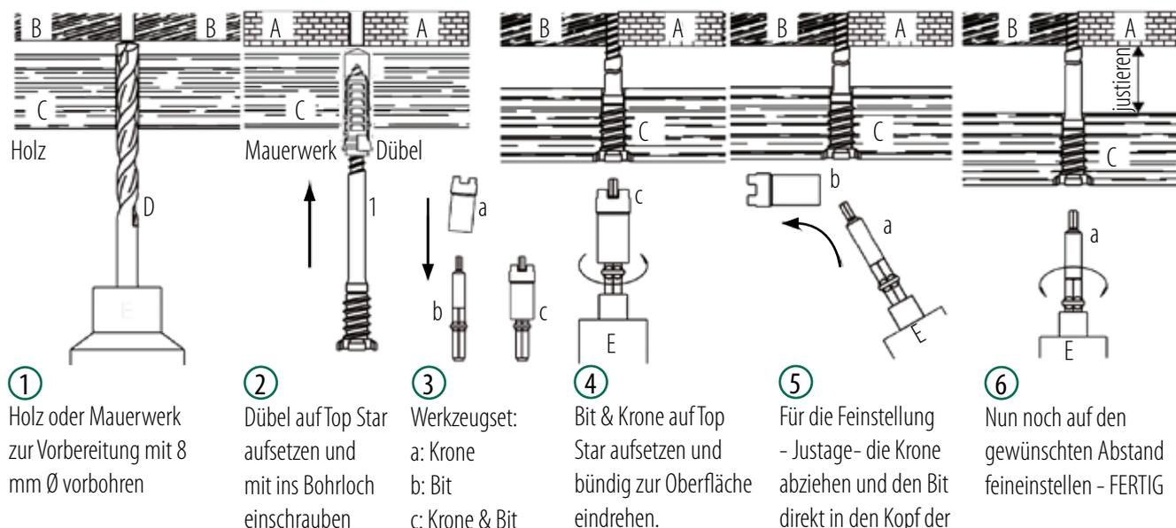
① Holz oder Mauerwerk zur Vorbereitung mit 8 mm Ø vorbohren
